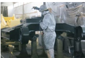
油圧ショベルのフレーム部の塗装風景
