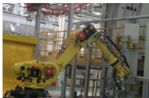
塗装装置へのハッチドア投入
